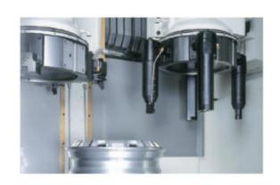
cnc龙门加工的优势:对被加工对象适应性强。更换加工对象时,除了更换刀具和解决毛坯的装夹方式外,只需重新编程,不需要其他复杂的调整,缩短了生产准备周期。加工精度高,质量稳定。加工尺寸精度在0.005~0.01 mm之间,不受零件复杂程度影响。由于大多数操作都是由机器自动完成的,因此消除了人为错误,并提高了批量零件尺寸的一致性。同时,在精密控制机床上使用了位置检测装置,进一步提高了数控加工的精度。易于与计算机建立通信,实现群控。由于机床是由数字信息控制的,很容易与计算机辅助设计系统连接,形成一个集成的CAD/CAM系统,也很容易实现成组控制。日本工具机日本大隈CNC外圆磨床五轴加工中心作为自动化程度高的智能加工设备常被用于制造中。
