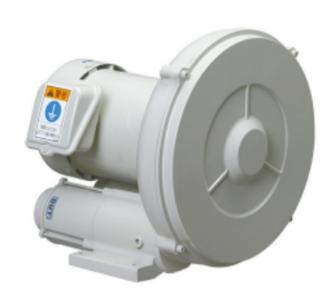
1. 仔细阅读风机使用说明书及产品样本,熟悉和了解风机的规格、形式、叶轮旋转方向和气流进出方向等;再次检查风机各零部件是否完好,否则应待修复后方可安装使用。[4] 2. 风机安装时必须有安全装置以防止事故发生,并由熟悉相关安全要求的专业人士安装和接线。3. 联接风机进出口的风管有单独支撑,不允许将管道重叠重量加在风机的部件上;风机安装时应注意风机的水平位置,对风机与地基的结合面与出风管道的联接应调整,使之自然吻合,不得强行联接。4、风机安装后,用手或杠杆拨动叶轮,检查是否有过紧或擦碰现象,有无妨碍转动的物品,无异常现象下,方可进行试运转,风机传动装置的外露部份应有防护罩(用户自备)如风机进风口不接管道时,也需添置防护网或其他安装装置(用户自备)。5. 风机所配电控箱必须与对应风机相匹配(指功率、电压、气动方式、控制形式等)。6. 风机接线应由专业电工接线,接线必须正确可靠,尤其是电控箱处的接线编号与风机接线柱上的编号一致对应,风机外壳应可靠接地,接地必须可靠,不能用接零代替接地。日本东宇为您提供鼓风机,欢迎您的来电!台制接纸机鼓风机原理
